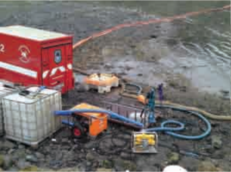
Mynd 1: Skimmarin hjá Tórshavnar kommunu varð brúktur at skúma oljuna omanav sjónum og pumpa niðan í tangar.
