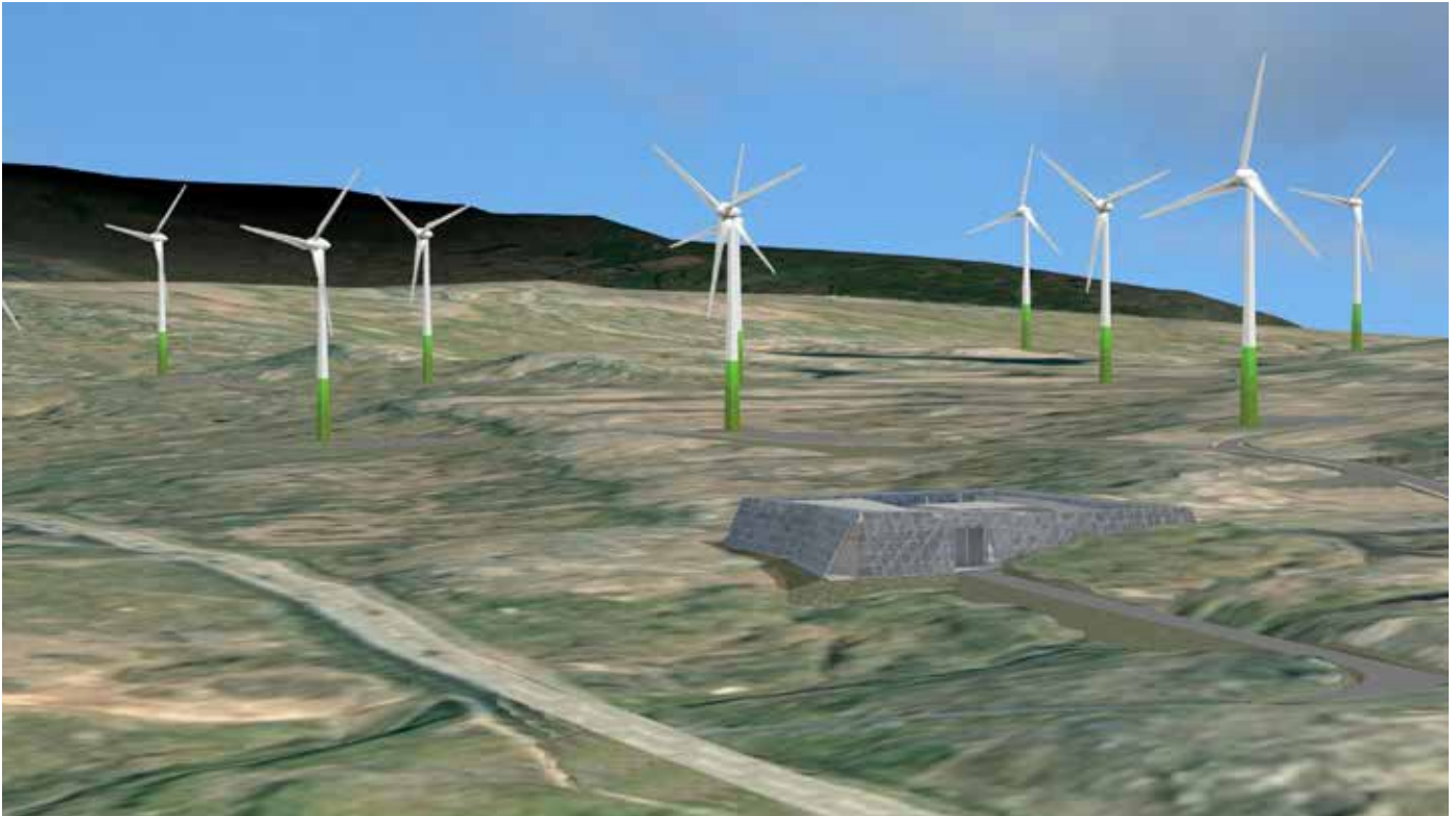
Teldugjörd royndarmynd av vindmyllulundini í Húsahaga. Koplingarstöðin, sum verður bygd saman við vindmyllunum, sæst frammarlaga í myndini. Virtual model of the Húsahagi wind farm. In the foreground is the transformer coupling station that will be built in association with the wind turbines.
